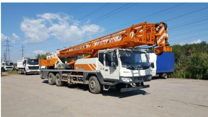
Автокран Zoomlion Qy16v441. Грузоподъемность 16 т, вылет стрелы 29м, колесная формула 6х4. Используется при строительно-монтажных работах, погрузка – разгрузка грузов.
