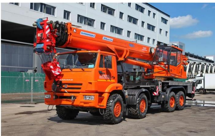
Автокран КС-65719-3К-1 на шасси КАМАЗ-63501-41 повышенной проходимости. Грузоподъемность 40 т, вылет стрелы 29м, колесная формула 8х8. Используется при строительно-монтажных работах, погрузка – разгрузка грузов.
