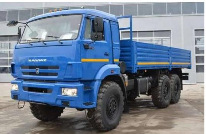
Грузовой автомобиль КАМАЗ-43118 повышенной проходимости. Грузоподъемность до 11т, колесная формула 6х6. Размеры кузова 6100х2320х500мм. Используется для перевозки различных грузов, буксировки прицепов, траля
