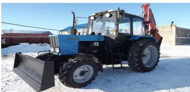
Экскаватор ЭО-2621 на базе трактора МТЗ-82. Емкость заднего ковша - 0,25 куб.м., глубина копания до 3м. Используется при погрузке сыпучих материалов в строительстве, рытье траншей, разработке грунта и при землеройных работах.
