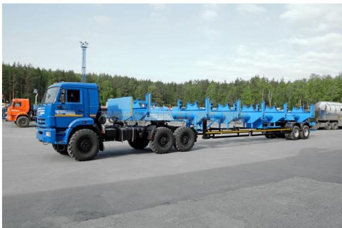
Опоровоз седельный тягач КАМАЗ-44108 с полуприцепом Уст-9465f. Грузоподъемность опоровоза 16т, колесная формула тягача 6х6, длина перевозимой опоры до 28 м.
