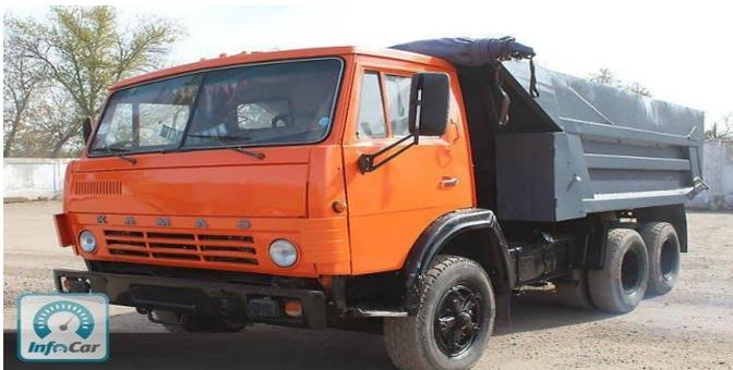
Автосамосвал КАМАЗ-5511. Грузоподъемность до 8т, колесная формула 6х4, кузов с задней разгрузкой, объем кузова 6,6 куб.м. Используется при перевозке сыпучих материалов (гравий, песок, грунт и пр.) и других грузов. Также используется при вывозе снега и мусора
