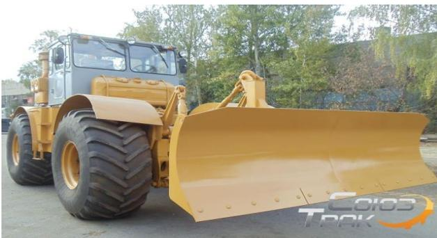
Трактора К-700. Колесная формула 4x4, мощность двигателя 300 л.с. Используется для выполнения противопожарной опашки с плугом и разработки грунта передним отвалом, расчистки территории и дорог от снега, также используется на сельскохозяйственных работах.
