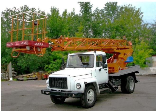
Автовышка АПТ-17М на шасси ГАЗ-3307. Высота подъема 17м, колесная формула 4х2. Используется при строительно-монтажных работах на воздушных линиях, работах выполняемых на высоте.
