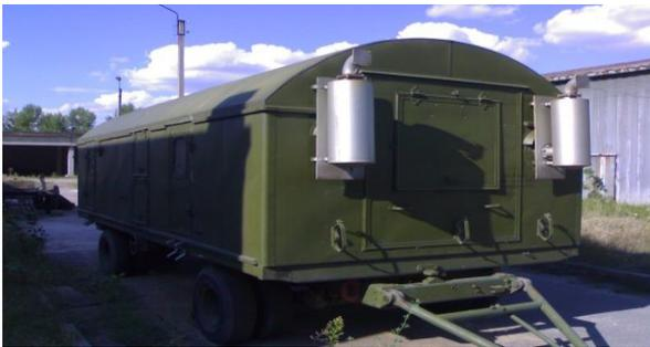
Передвижная дизельная электростанция 5Е-96. Мощность 100 кВт. Используется для подачи электроэнергии при аварийных отключениях.
