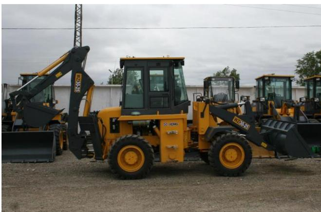
Экскаватор-погрузчик WZ30-25. Емкость заднего ковша - 0,3 куб.м., емкость фронтального ковша - 1,0 куб.м., глубина копания до 4,5м. Используется при погрузке сыпучих материалов в строительстве и в других сферах, рытье траншей, разработке грунта и при землеройных работах.
