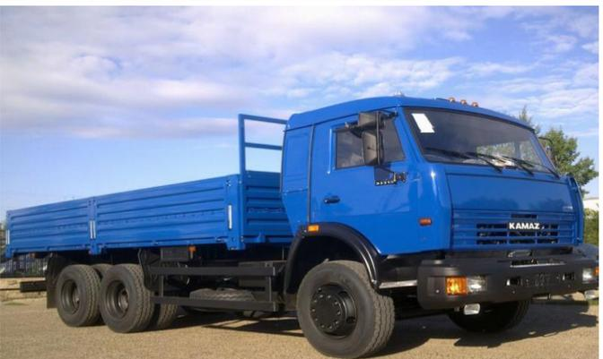
Грузовой автомобиль КАМАЗ-53215. Грузоподъемность до 11т, колесная формула 6х4. Размеры кузова 6100х2320х500мм. Используется для перевозки различных грузов, буксировки прицепов.
