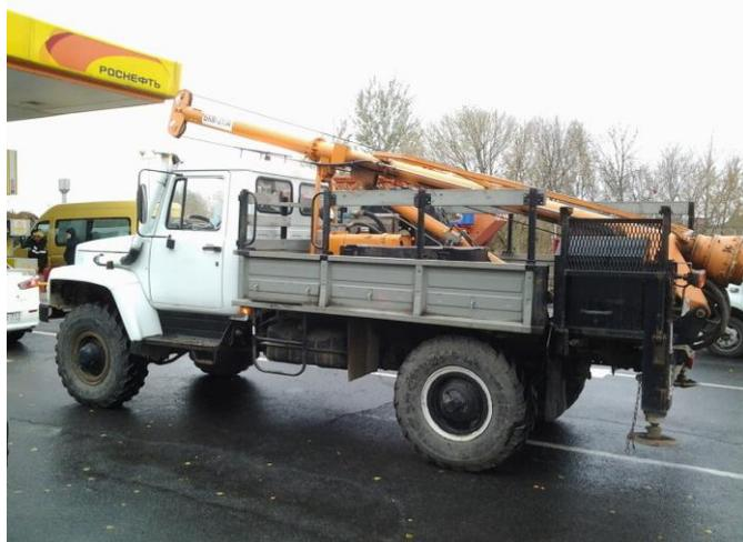
Бурильно-крановая машина БКМ-317 на шасси ГАЗ-3308. Диаметр бурения 0,25-0,8 м, глубина бурения до 3 м, колесная формула 4х4. Используется при строительно-монтажных работах на воздушных линиях, ямочно-бурильных работах при строительстве зданий и сооружений.
