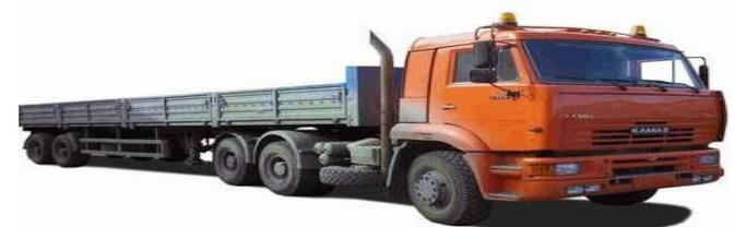
Длинномер седельный тягач КАМАЗ-54115 с бортовым полуприцепом. Грузоподъемность до 18т, колесная формула 6х4, размеры кузова 1200х2320х500мм. Используется для перевозки различных грузов, ЖБ опор и труб длиной до 12м.
