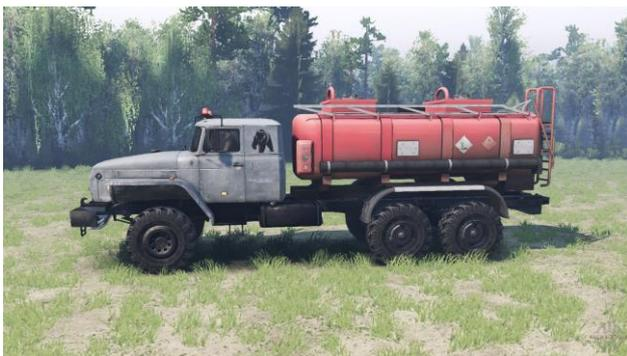
Масловоз на базе УРАЛ-5557 повышенной проходимости. Емкость цистерны 8000л, колесная формула 6x6. Используется для перевозки трансформаторных масел.
