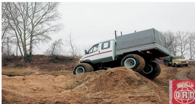
Снегоболотоход КЕРЖАК ТТС 30072. Грузоподъемность 1000 кг, колесная формула 4x4, количество посадочных мест 4 чел. Используется для передвижения бездорожья в болотистых и заснеженных местностях, где нет возможности проезда автомобилей.
