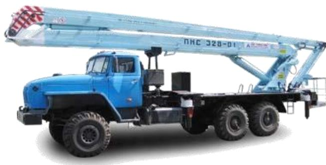
Автовышка ПМС-328-01 на шасси УРАЛ-4320 повышенной проходимости. Высота подъема 28м, стрела трехколенная, колесная формула 6х6. Используется при строительно-монтажных работах на воздушных линиях, работах, выполняемых на высоте.
